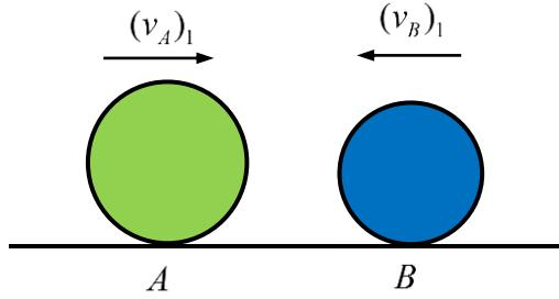
$$m_A(v_A)_1 + m_B(v_B)_1 = m_A(v_A)_2 + m_B(v_B)_2 \quad (1)$$
